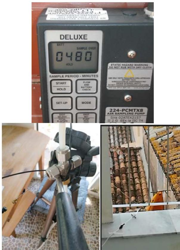
Figura 6. Detalle del sistema de toma de muestras de aire
